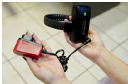
**Foto 12.** Modelo de tornozeleira eletrônica com recarga na tomada elétrica
