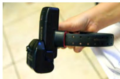
**Foto 13.** Modelo de tornozeleira eletrônica com bateria acoplada
