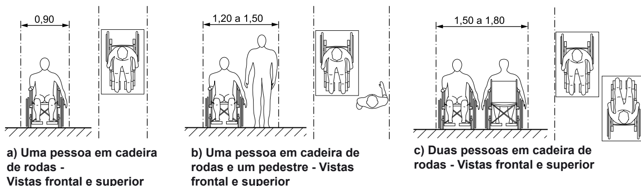
Figura 16: largura para deslocamento de pessoas em linha reta. Demais especificidades de dimensões, inclinações, informação, etc., estão disponíveis na NBR 9050/2020. 84
