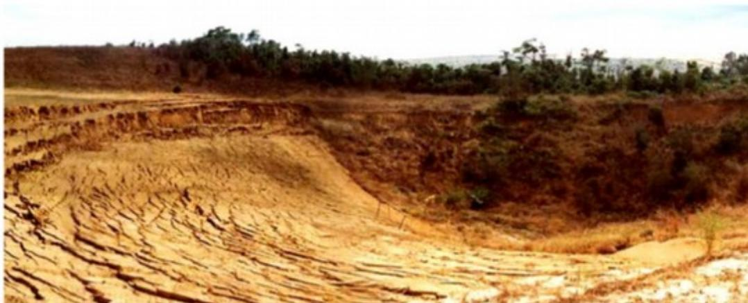
**Figura 2.3 – Uma das três áreas colapsadas na mina de potássio de Holle-Congo.**
